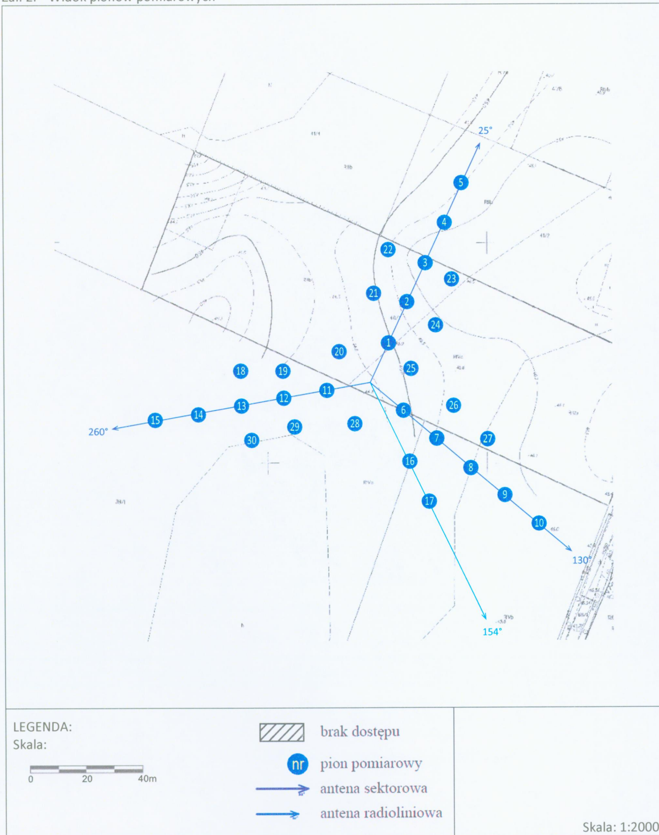
Zař. 2. Widok pionów pomiarowych
